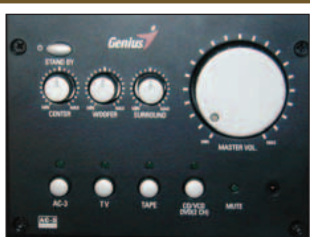
На передней панели сабвуфера располагаются кнопки переключения звуковых входов и регулятор общей громкости и баланса сателлитов/бас.
