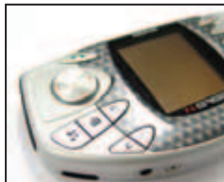
Кнопки для быстрого включения радио, MP3-плеера и вызова основного меню. Почему-то места для аналогичного запуска игры не нашлось.
